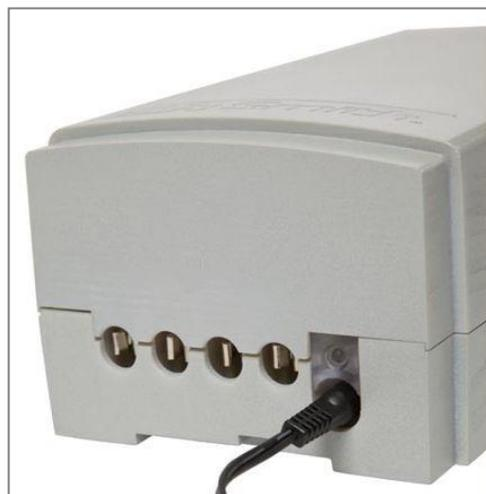
Non è necessario scaricare completamente la batteria prima di caricarla. La batteria deve essere caricata quotidianamente e non può essere sovraccaricata. Ci vogliono fino a dodici ore per caricarla completamente, a seconda dell'uso della batteria. Non lasciare che la batteria si scarichi completamente, in quanto ne riduce la durata.
